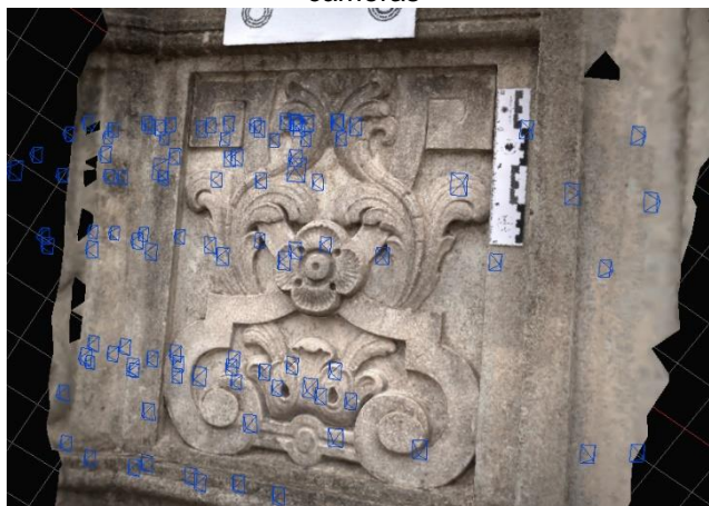
Figura 20 – Detalhe da interface do 3DF Zephyr mostrando a malha poligonal e a posição das câmeras
