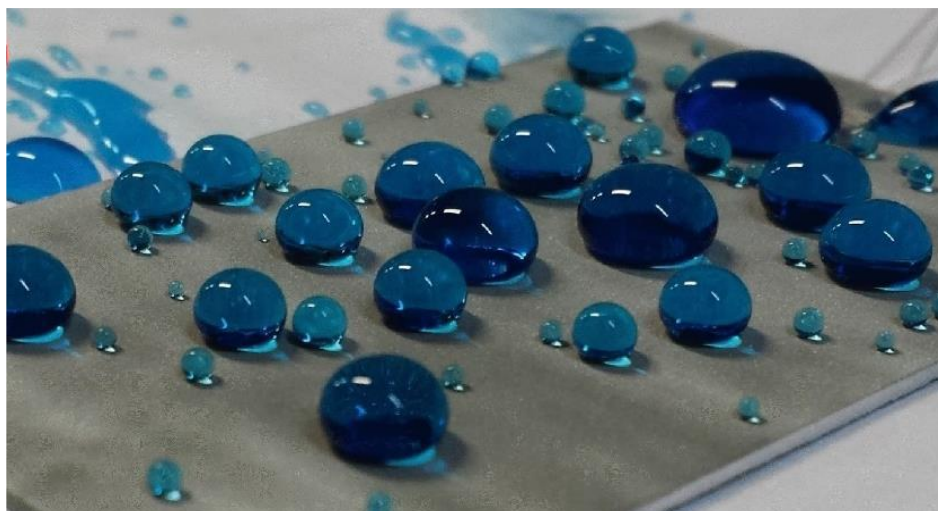
Figura 64. Foto da amostra J-SA com gotas de azul de metileno depositadas.
