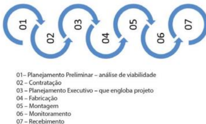
Figura 19 – Etapas do processo construtivo industrializado
