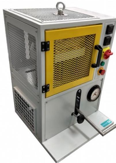
*Figura 10: Prensa utilizada para confecção das placas*
