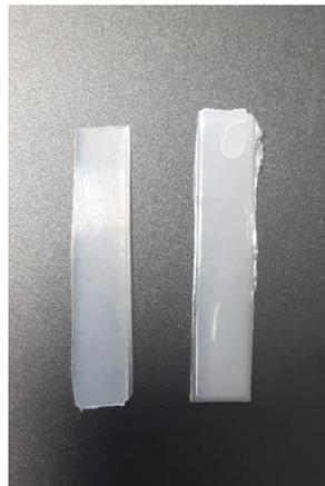
*Figura 11: Exemplo de corpo de prova para refratometria*
