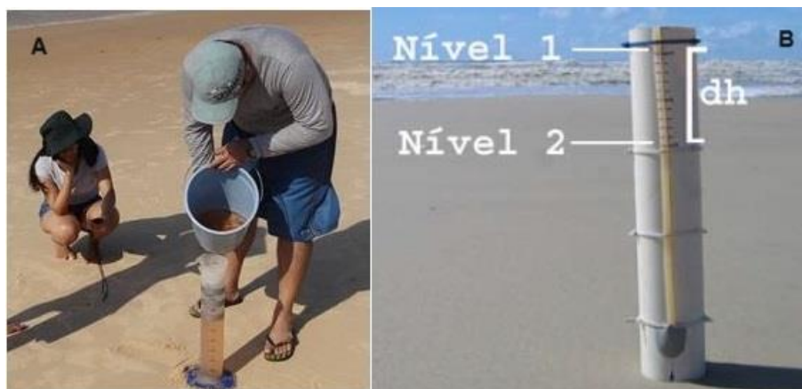
Figura 1.4: Ensaio de 'tubo aberto'. (A) Ensaio de permeabilidade ao óleo. Fonte: Lopes (2016). (B) Tubo mostrando os níveis de variação. Fonte: Pereira (2005)
