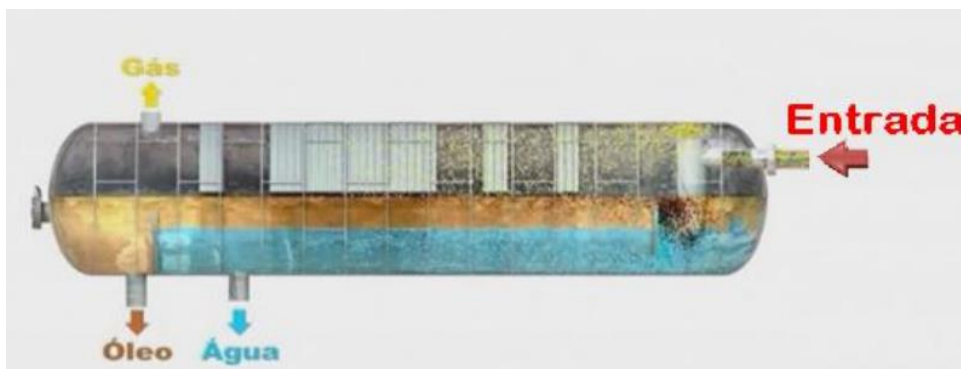
Figura 2.1: Representação de um separador trifásico
