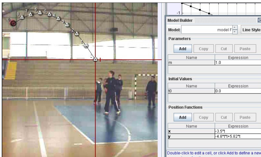
Figura 5.10: Captura de tela que mostra o recurso “Construção de modelos” do programa Tracker e as equações temporais do movimento nas direções horizontal ( x ) e vertical ( y ).
