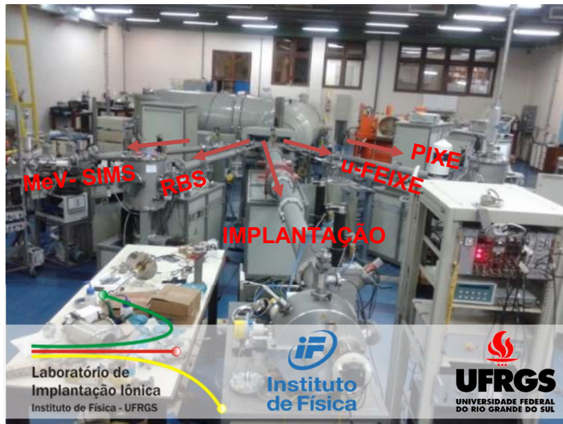
Figura 5: Foto do acelerador de íons Tandatron e das respectivas linhas experimentais. [Imagem por Dr. Deiverti V. Bauer].
