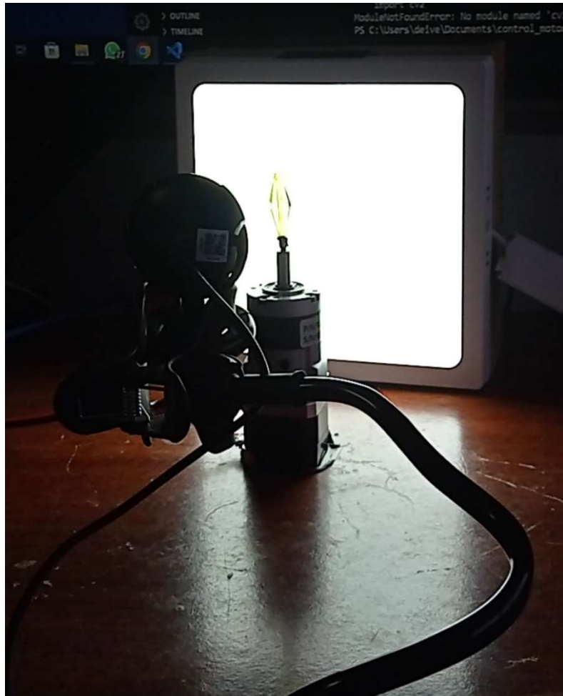
Figura 58: Configuração do experimento para validação do algoritmo FBP.
