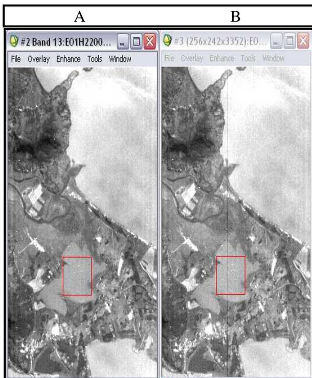
Figura 11: Imagem Hyperion, banda 13, (A) com correção dos *stripes* e (B) imagem original no nível L1R.
