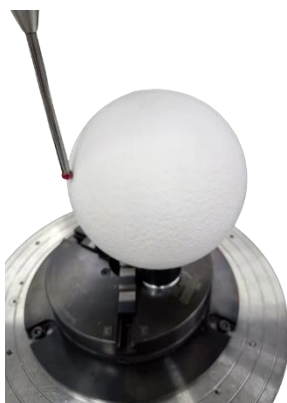
Figura 88 - Apalpador realizando as medidas na esfera.
