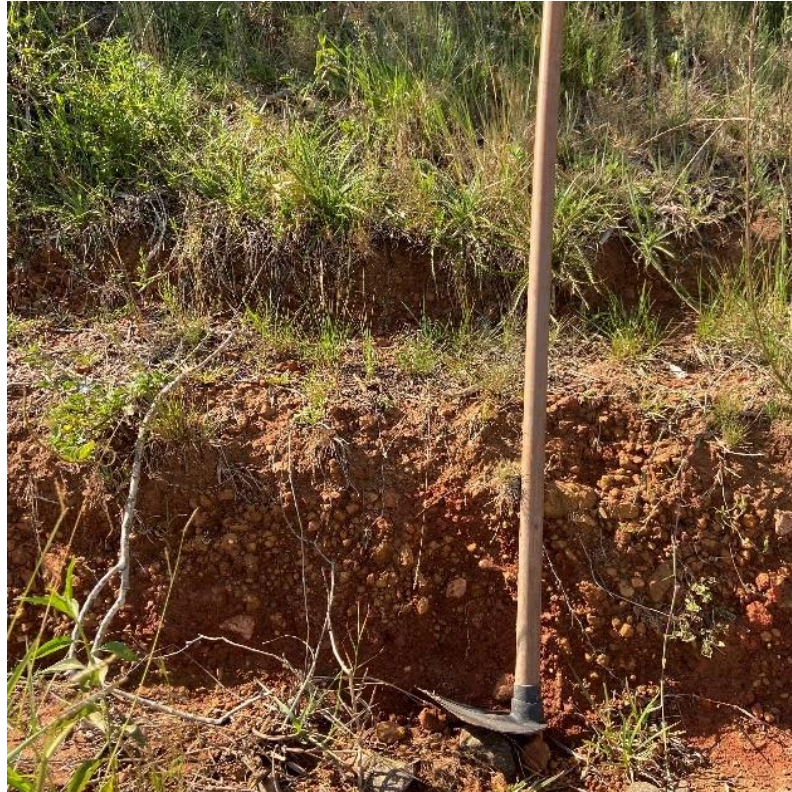
Figura 9. Perfil de verificação da ocorrência de concreções ferruginosa
