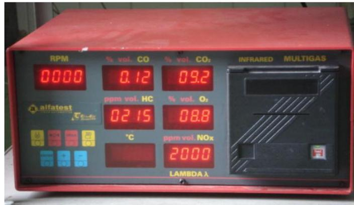
Figura 3.4 – Analisador de gases da AlfaTest.
