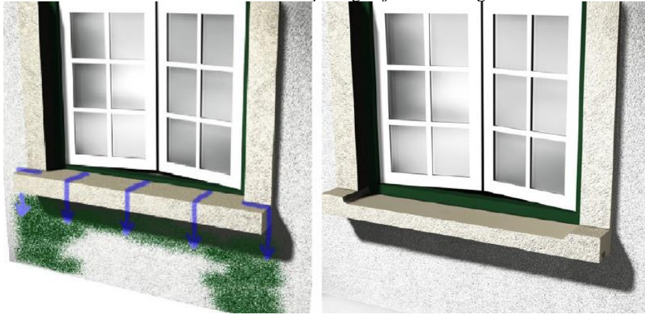
Figura 66 – Possível solução para o problema de manchamento nos peitoris de janelas (esquerda): introdução de elementos de condução e gotejamento da água
