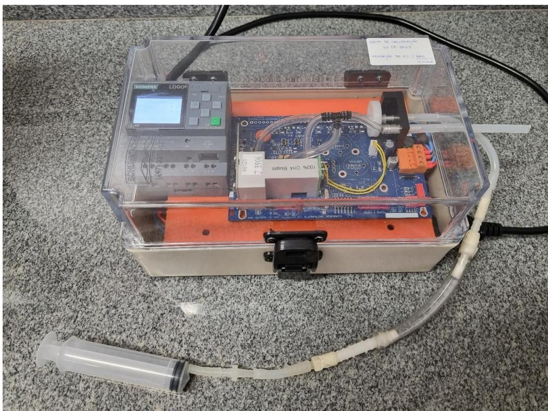
**Figura 16.** Equipamento utilizado para análise da qualidade do biogás na primeira etapa experimental (*Gascard NG*, Edinburgh Sensors).
