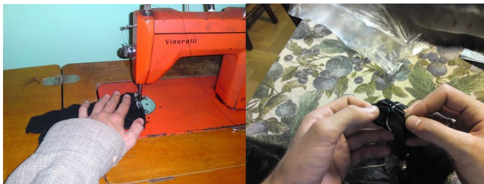
Figura 3.4: Processo de costura das luvas: moldes de pano costurados à máquina (esq.) e componentes eletrônicos costurados à mão (dir.).
