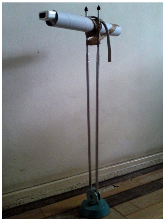
Figura 6.1: O suporte construído para manter o Wiimote em uma posição fixa.
