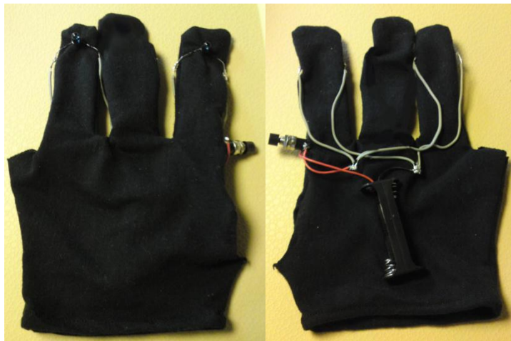
Figura 3.1: a uiGlove direita – palma da mão abriga os dois LEDs e as costas da mão carregam as pilhas em seu suporte e a ligação de fios.
