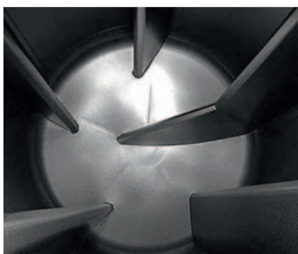
Figura 6 – Design das haletas do tumbler Fonte: CFS, 2010.
