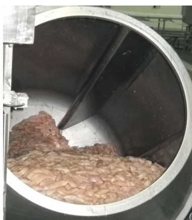
Figura 7 – Foto do tumbler carregado
