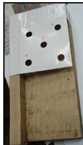
Figura 48: base de madeira com 5 orifícios no gabarito
