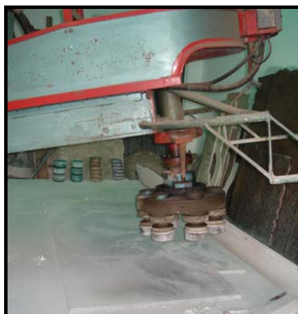
Figura 43: politriz utilizada no acabamento superficial
