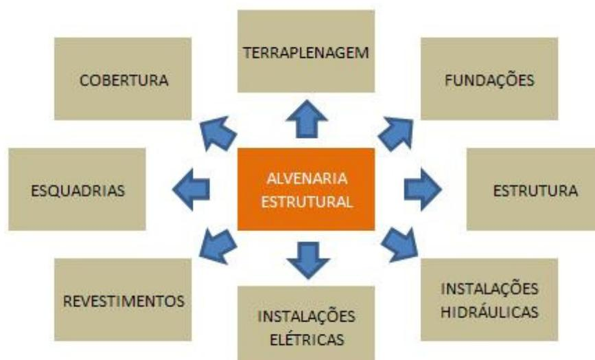
Figura 2 – Compatibilização entre a alvenaria estrutural e os subsistemas (baseada em MANZIONE; 2007, p. 14)
