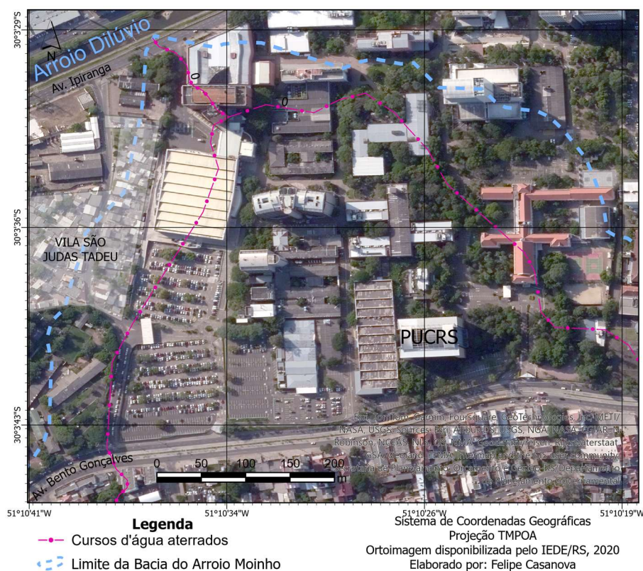
Figura 37: Planícies fluviais aterradas do Arroio Dilúvio. Destaque ao fato de que toda a porção inferior da Bacia do Arroio Moinho e sua foz é densamente construída com pavimentação asfáltica, reduzindo os processos de infiltração da água e aumentando o escoamento superficial. Grande parte do canal principal, em sua extensão próxima à foz, foi tamponada e canalizada. Fonte: elaboração própria (2024).
