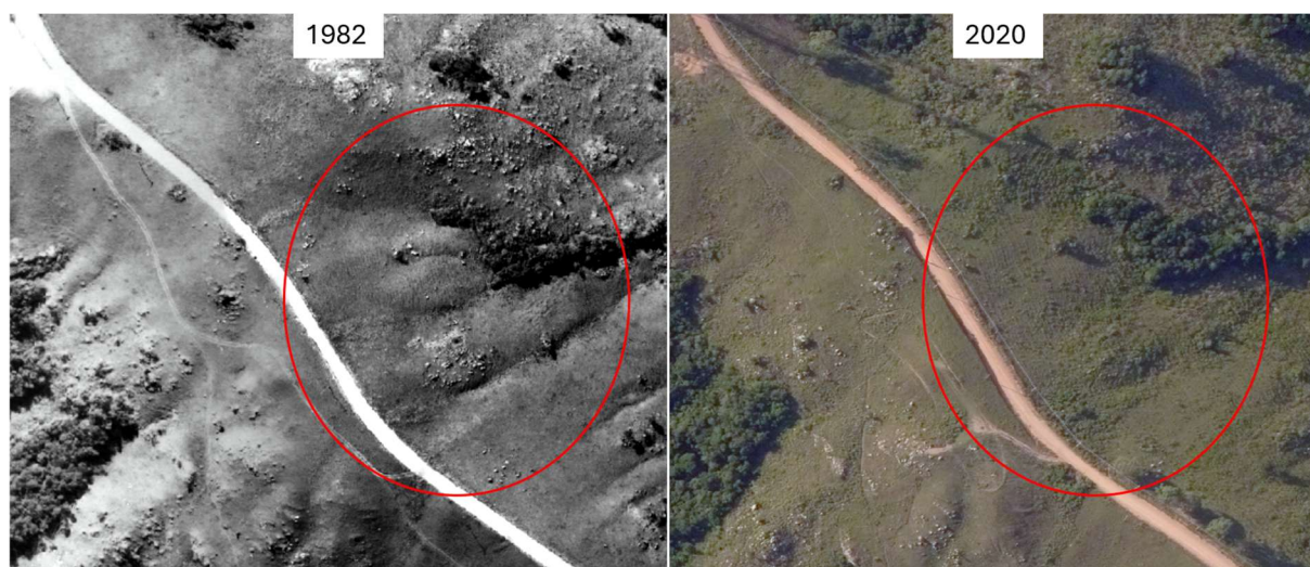
Figura 45: Fotografias aéreas com destaque aos degraus de abatimento. Percebe-se que os degraus apresentam feição linear seguindo a convexidade da vertente, localizando-se em área próxima ao topo. Fonte: Adaptado de: fotografia de 1982 – Biblioteca do IGEO UFRGS; fotografia de 2020 – DEPLAN/RS.
