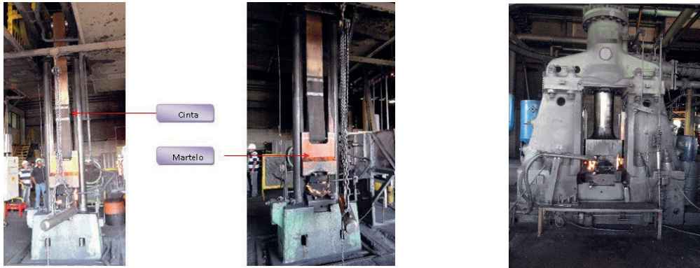
Figura 17: Martelo de forjamento de queda livre (esquerda) e Martelo pneumático (direita) Fonte: FIERGS (2012)
