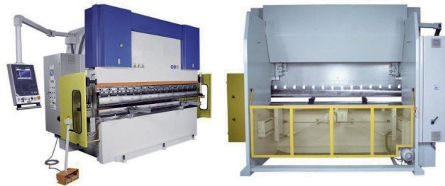
Figura 13: Dobradeira Hidráulica com proteção frontal, lateral e traseira Fonte: FIERGS (2012)
