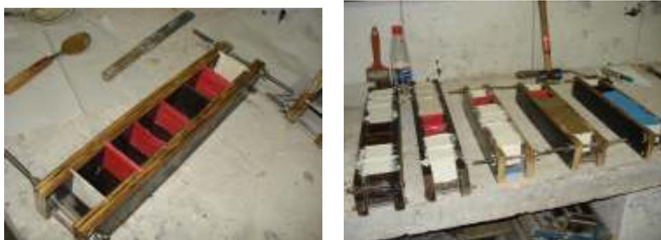
Figura D2: fôrmas para corpos-de-prova
