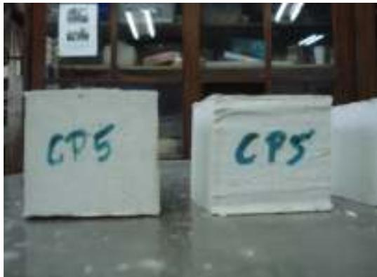
Figura 57: detalhe da porosidade no corpo-de-prova 5
