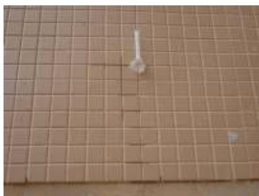
Figura C15: permeabilidade do rejunte – Obra 10 (pavimento inferior)
