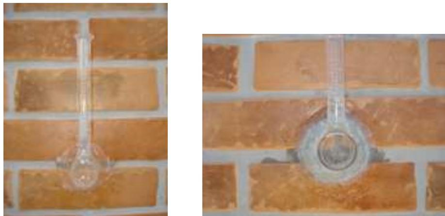
Figura C1: permeabilidade do rejunte – Obra 1
