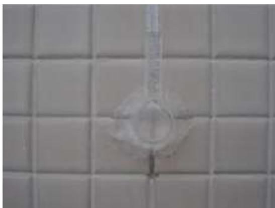
Figura C11: permeabilidade do rejunte – Obra 8
