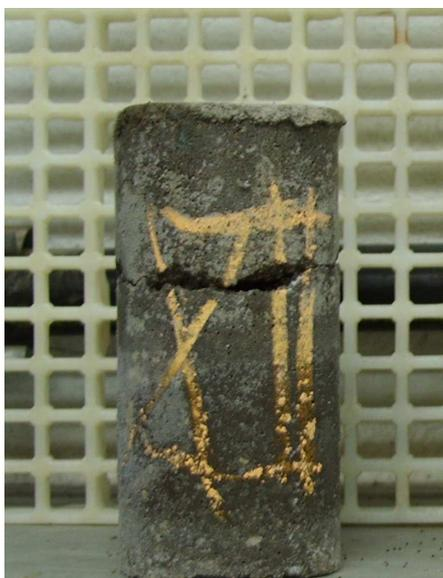
Figura 10: corpo-de-prova quebrado a 2/3 da altura
