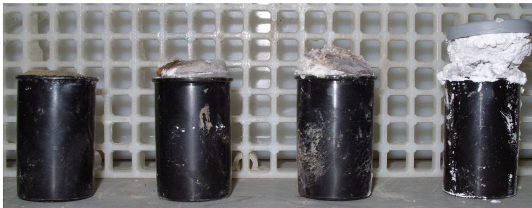
Figura 5: pastas com teores de ativador de 2,5, 5, 10 e 20% (esquerda para direita) com temperatura de cura de 60°C
