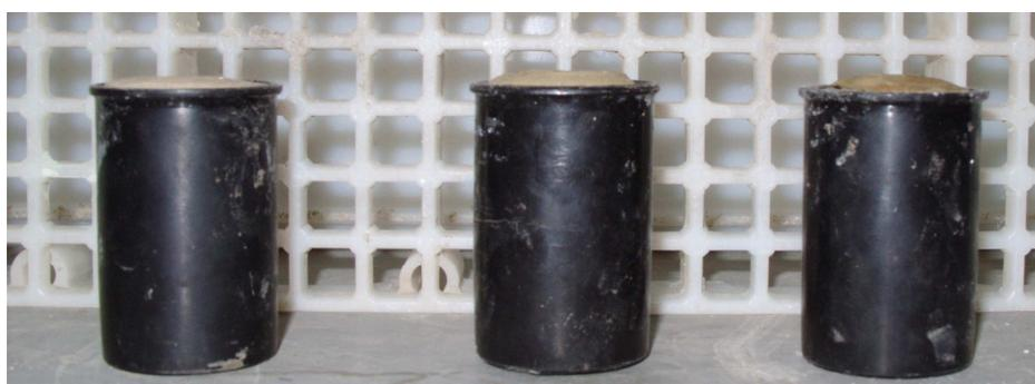
Figura 6: pastas com teores de ativador de 1,5, 2,5, 3,5% (esquerda para direita) com temperatura de cura de 60°C
