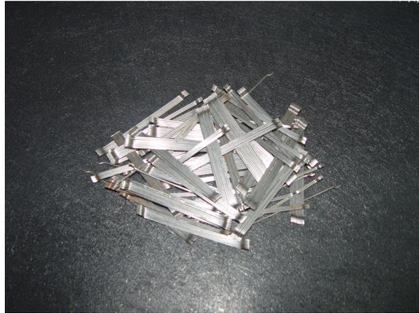
Figura 11: fibras de aço utilizadas na pesquisa
