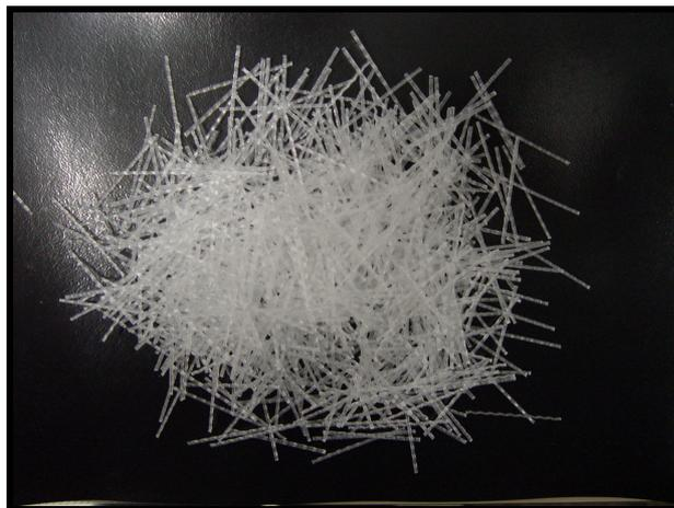
Figura 12: fibras de polipropileno utilizadas na pesquisa
