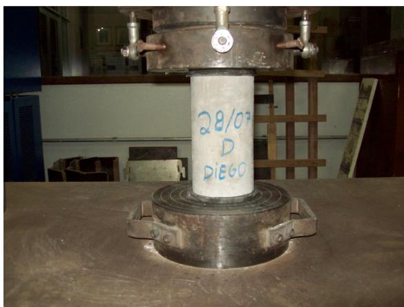
Figura 13: ensaio de compressão axial simples
