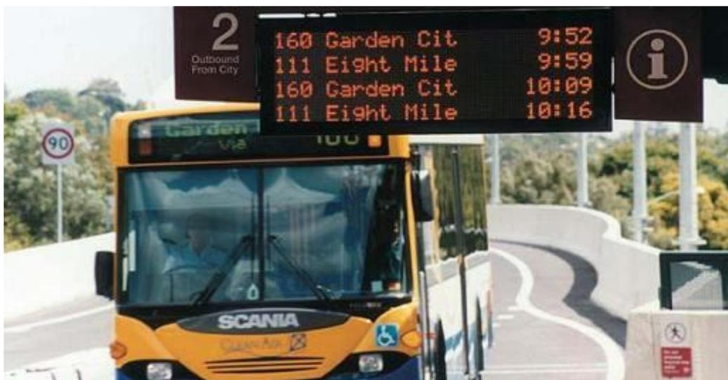
Figura 13: painel eletrônico de informação ao usuário em Brisbane, Austrália (WRIGHT; HOOK, 2008, p. 347)
