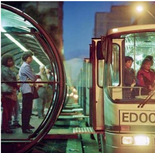
Figura 10: embarque em nível com ponte em Curitiba, Brasil (WRIGHT; HOOK, 2008, p. 281)
