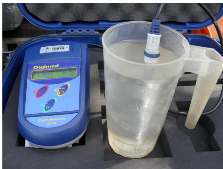
Figura 5 - Condutivímetro DM-3P Digimed.
