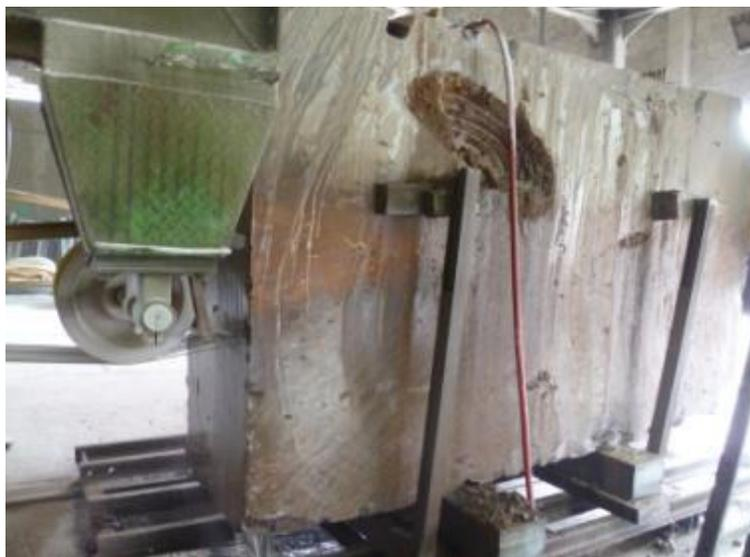
Figura 39. Bloco de riodacito sendo serrado em uma máquina de fio diamantado.
