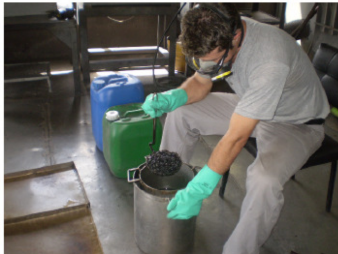
Fig. 5.2.2 – Retirada do material flutuante no meio denso.
