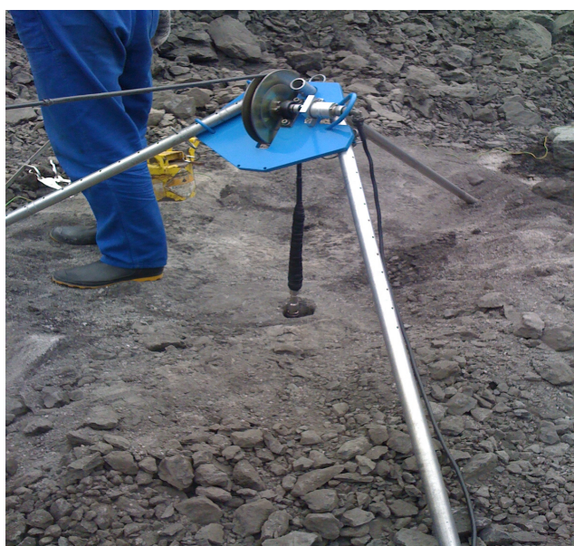
Fig. 5.1.2 Sonda sendo inserida no furo de sondagem
