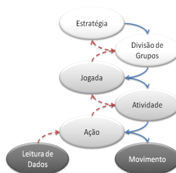
Figura 6.4: Conexões entre TCs no sistema de controle autônomo.
