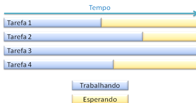
Figura 4.1: Tempo de execução e espera de quatro tarefas desbalanceadas executando em paralelo. O tempo total de execução é o tempo da tarefa mais lenta.
