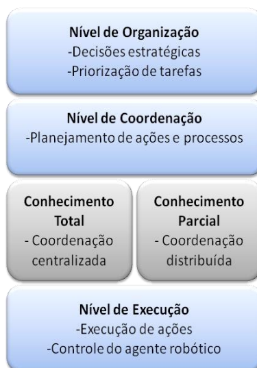
Figura 6.2: Estrutura funcional de uma célula robótica inteligente como definida em (JACAK, 1999).
