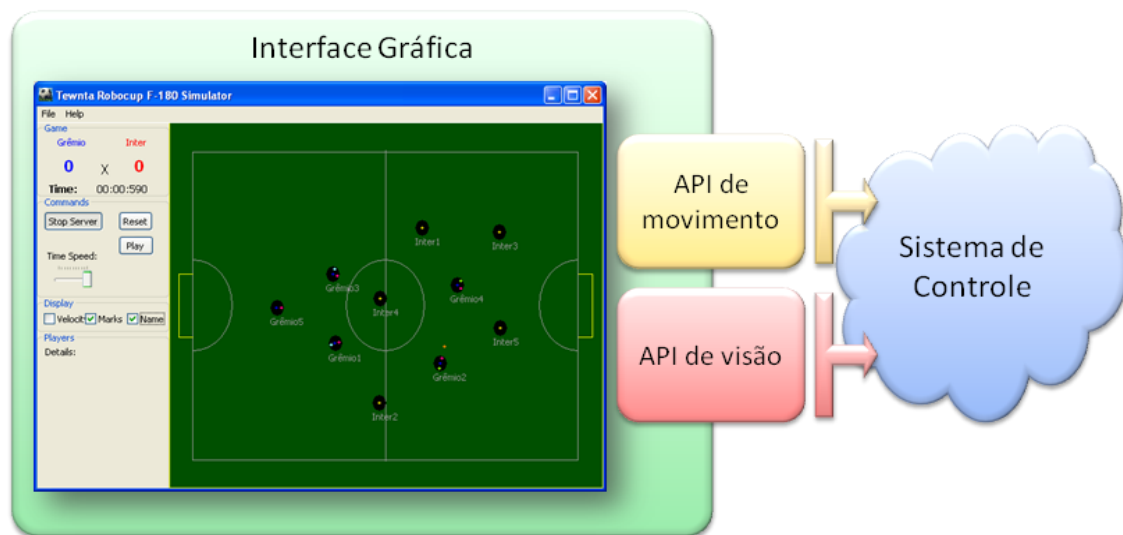
Figura 7.14: Principais componentes do ambiente simulado.
