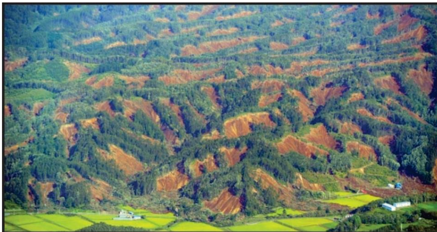
Figura 136. Deslizamento de terra causado pelo terremoto de Hokkaido em 2018 no Japão (fonte: crédito foto: JIJI PRESS. AFP)
