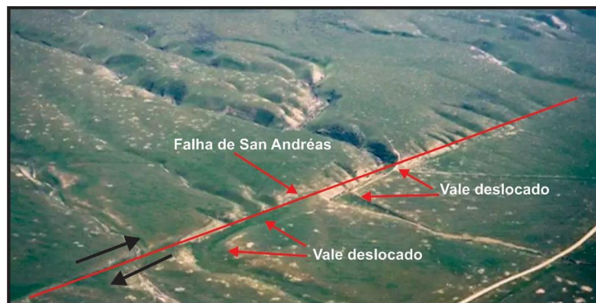
Figura 100. Esquema do movimento lateral da falha de San Andrés interpretado a partir do deslocamento dos vales de drenagem. (modificado: https://cdn.serc.carleton.edu/images/vignettes/collection/figure_2_wallace_creek.webp )
