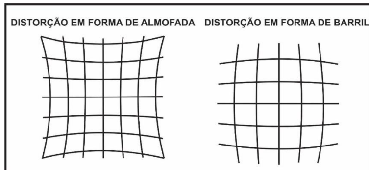
Figura 47. Representação esquemática das distorções em forma de almofada e de barril. (modificado: https://lesdeuxpiedsdehors.com/wp-content/uploads/2022/06/les-distorsions-en-photographie.png )
