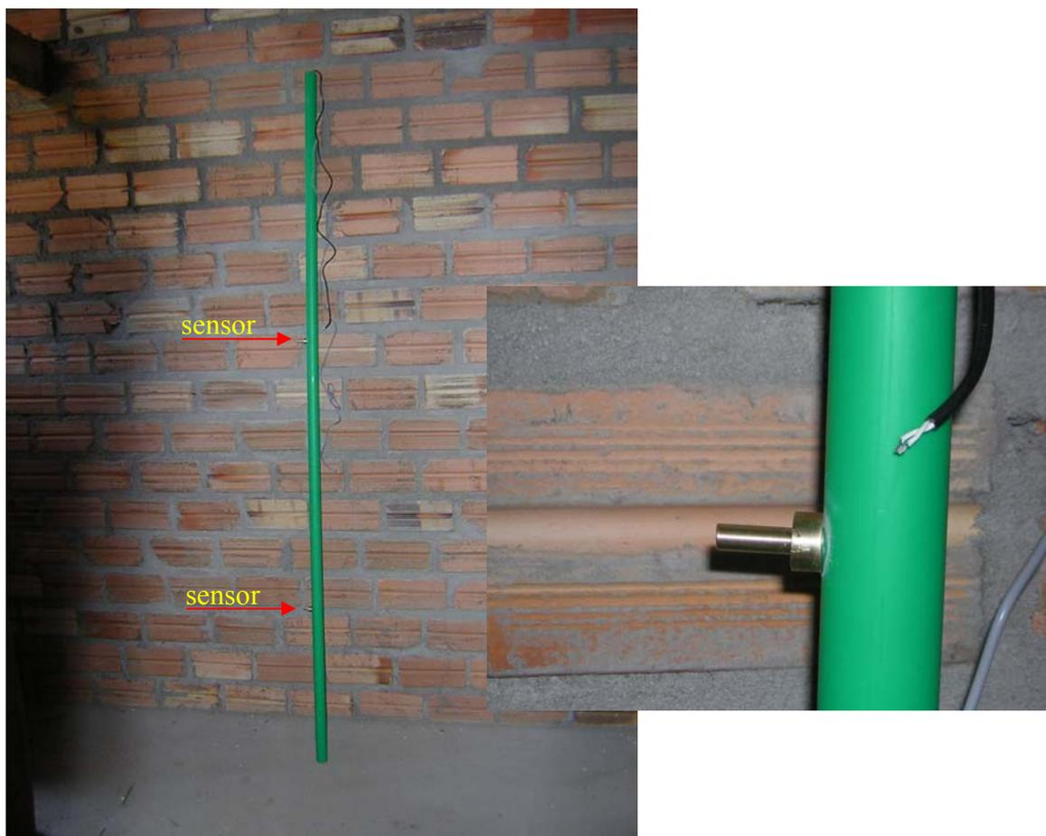
Figura 37: Bainha metálica para proteção dos sensores no reservatório d'água
