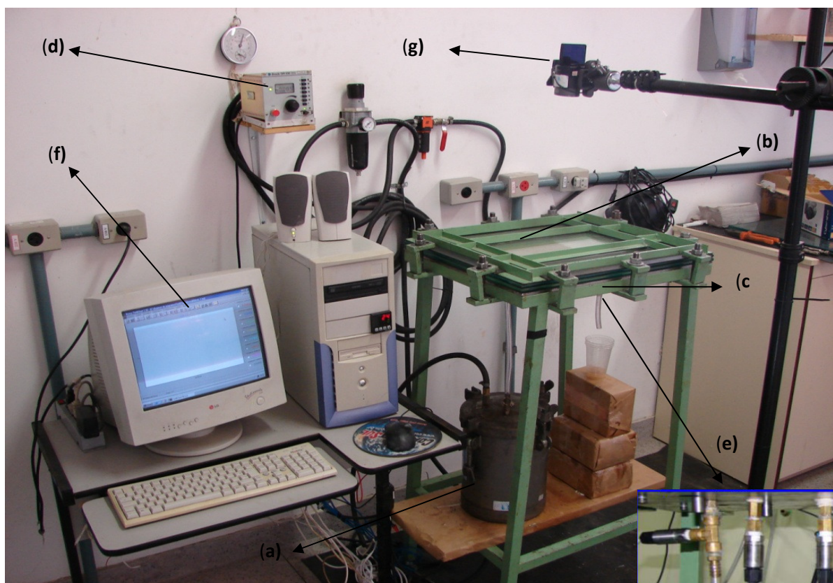
Figura 10- Foto do aparato experimental RTM do LACOMP/UFRGS: (a) Vaso de pressão, (b) Molde superior em vidro reforçado, (c) Molde inferior em aço, (d) Controlador de pressão ( Druck ), (e) Transdutores de pressão, (f) Sistema de aquisição de dados e (g) Câmera.
