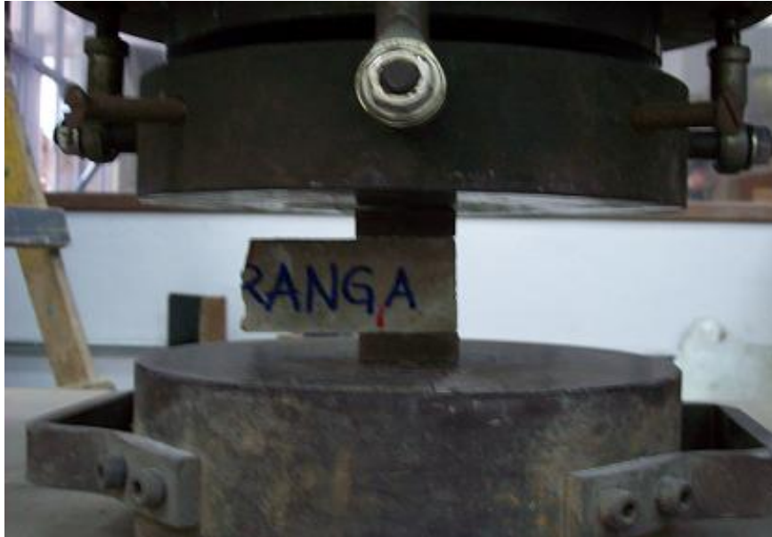
Figura 4.12: Corpos-de-prova prismáticos submetidos à compressão axial.
