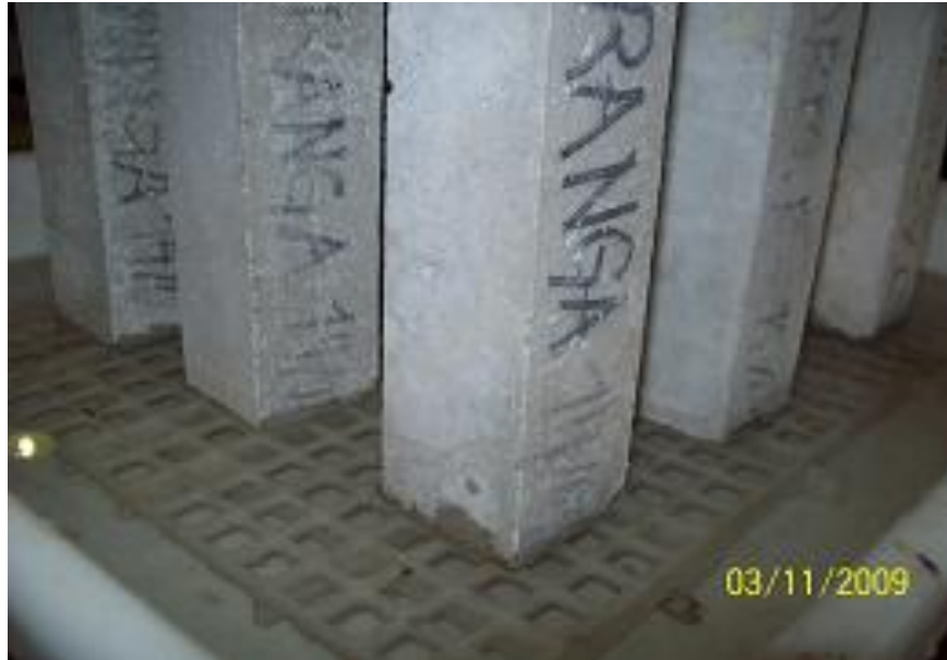
Figura 4.10 - Corpos-de-prova em ensaio de absorção por capilaridade
