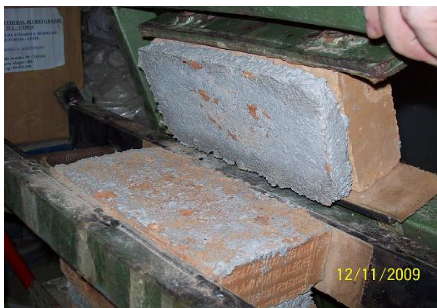
Figura 6.10: Aspecto do bloco cerâmico, após o ensaio de aderência das juntas, com mesma argamassa da Figura anterior.
