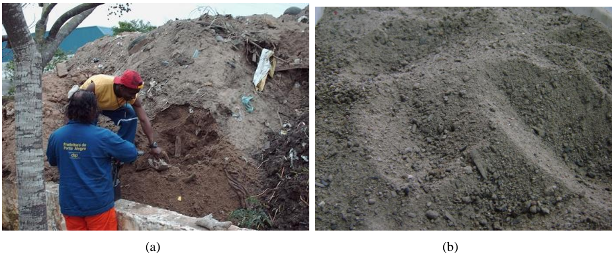
Figura 5.4: Coleta do sedimento (a) e características da areia Dilúvio após higienização (b).
