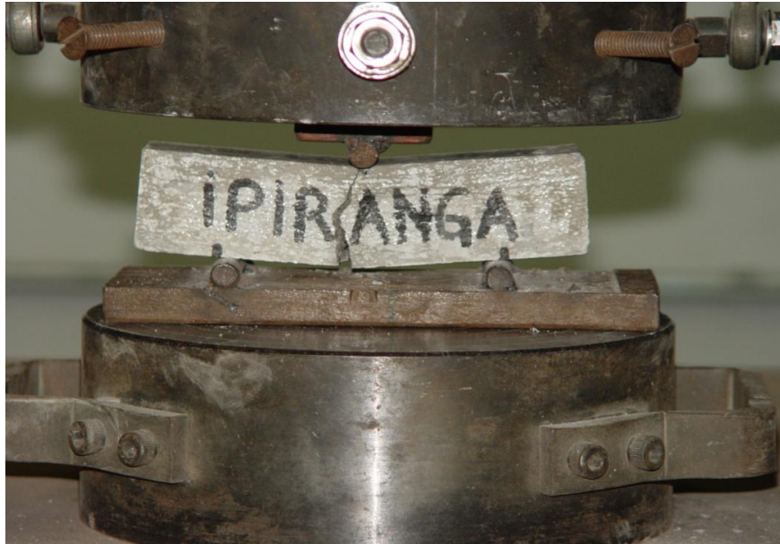
Figura 4.13: Corpos-de-prova prismáticos submetidos à tração na flexão
