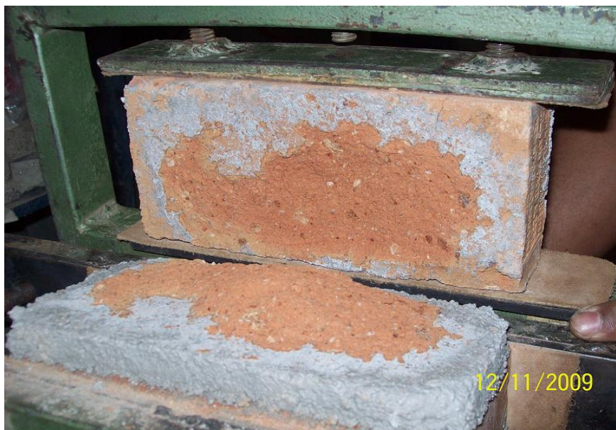
Figura 6.9: Aspecto do bloco cerâmico após o ensaio de aderência das juntas.
