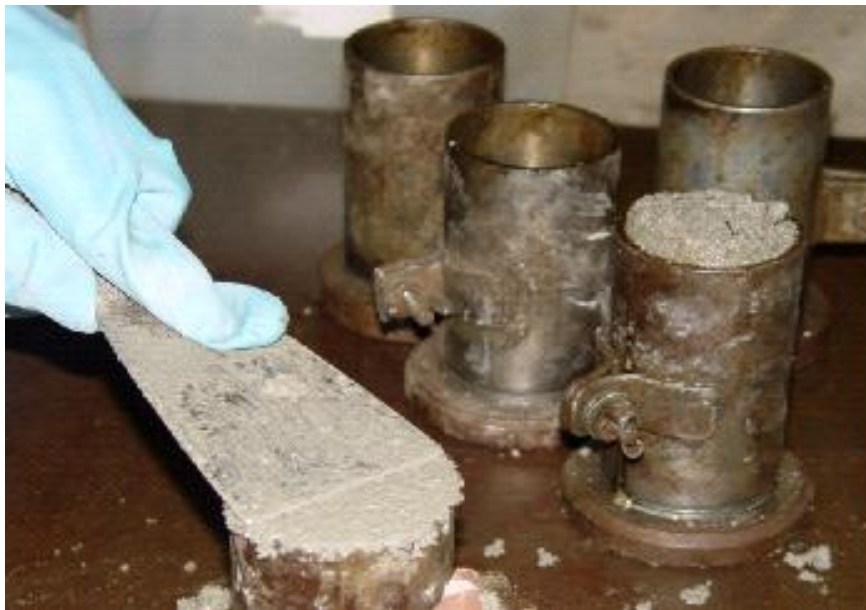
Figura 4.16 – Moldagem dos corpos-de-prova cilíndricos.
