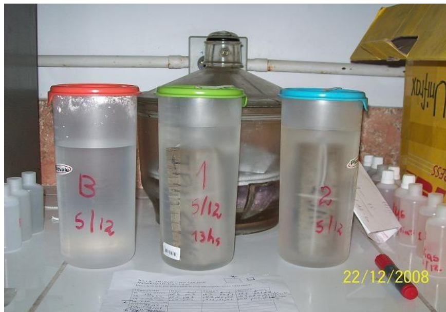
Figura 4.8: Ensaio do monólito conforme a norma NEN 7345(1995).
