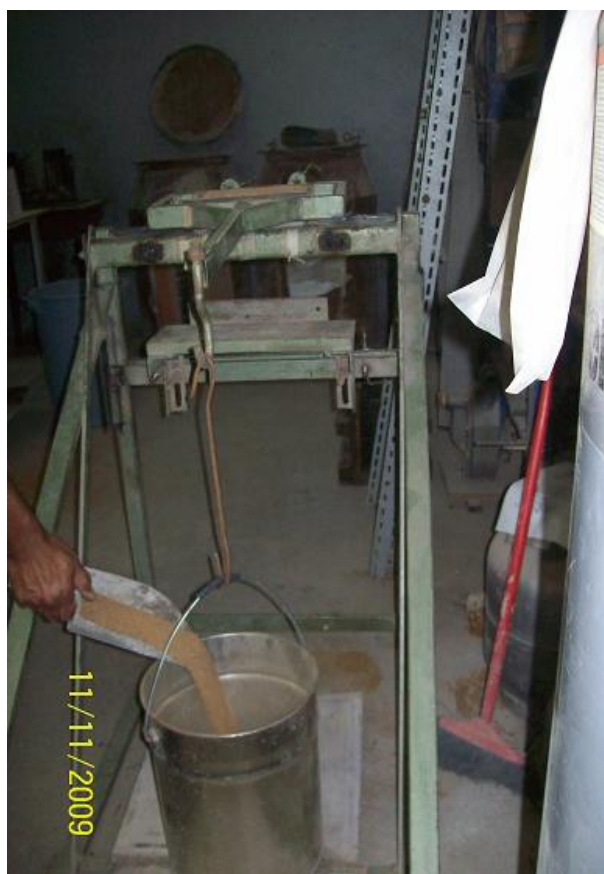
Figura 6.12: Ensaio de aderência das juntas em andamento.
