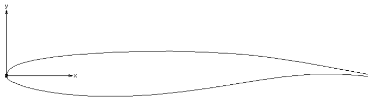
Figura 3.3 – Perfil do aerofólio OAT15A.
