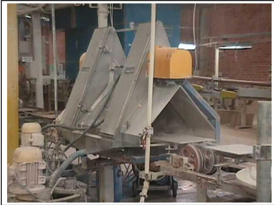
Figura 4.4. Técnica de esmaltação por cabine de disco.
