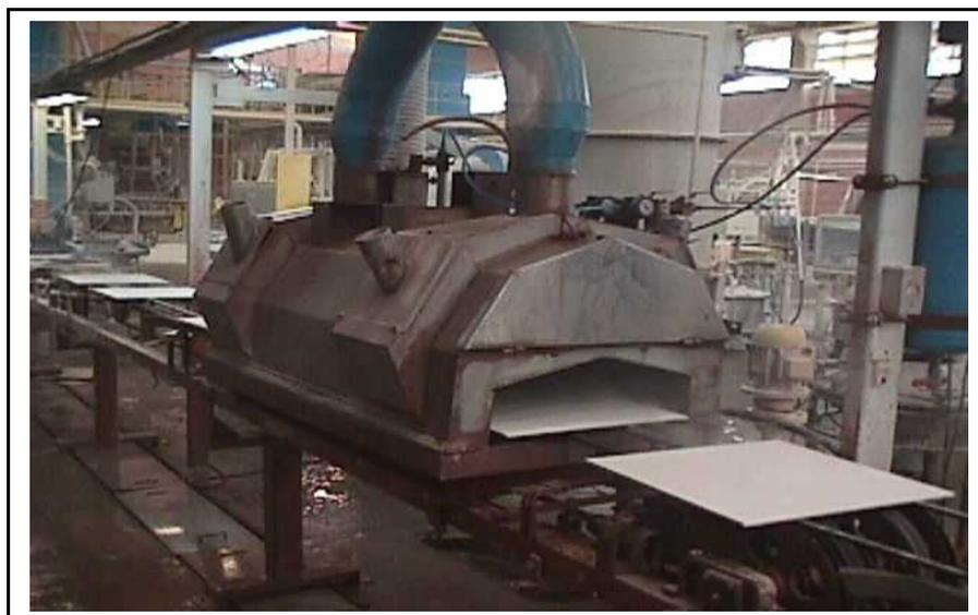
Figura 4.5 Técnica de esmaltação por sfumatura.
