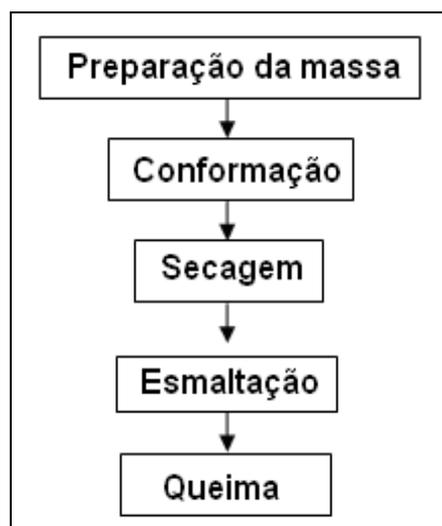
Figura 1.1 Fluxograma das etapas de fabricação de um revestimento cerâmico.
