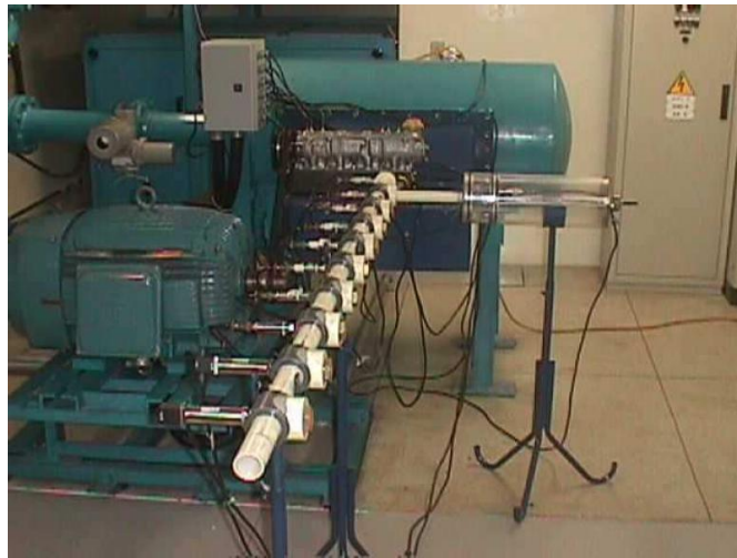
Figura 6.2. Ressonador de Helmholtz inserido na posição 2 [Hanriot, 2001].
