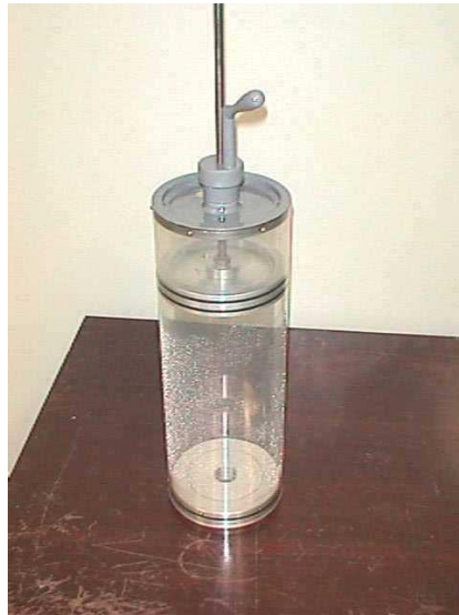
Figura 6.4. Detalhe do ressonador de Helmholtz [Hanriot, 2001].
