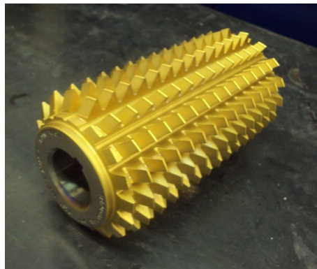
Figura 36 - Cortador caracol com revestimento de TiN
