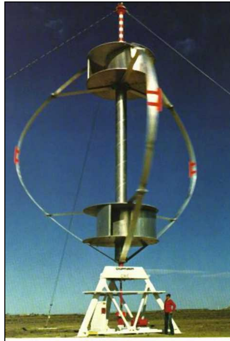
Figura 7 - Rotor tipo Darrieus
