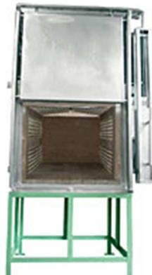
Figura 1.1 – Forno para recozimento térmico
