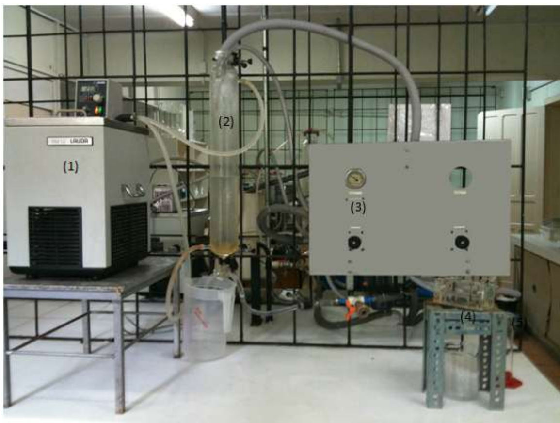
Figura 6.7 Fotografia do sistema de ultrafiltração utilizado: (1) banho termostático; (2) tanque; (3) manômetro de controle; (4) módulo de membrana e (5) coleta do permeado.
