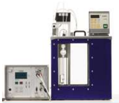
Figura 4.4 Imagem do viscosímetro capilar utilizado nos testes de viscosidade do suco de mirtilo. Fonte: Schott Instruments® < http://www.schottinstruments.com >.
