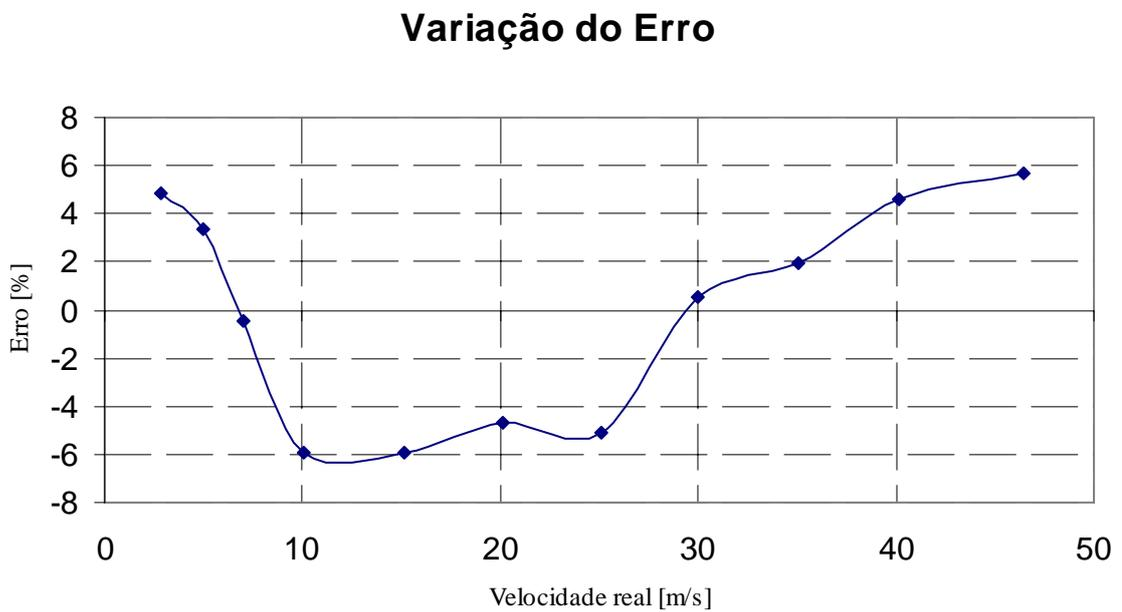
Figura B.2 – Variação do erro em função da velocidade.
