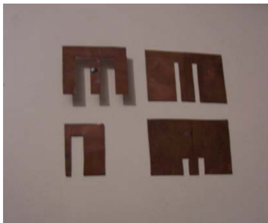
Fig. 2.1 – Antena “E”, com vistas do elemento irradiador de quatro protótipos usados no trabalho. O condutor é de cobre.
