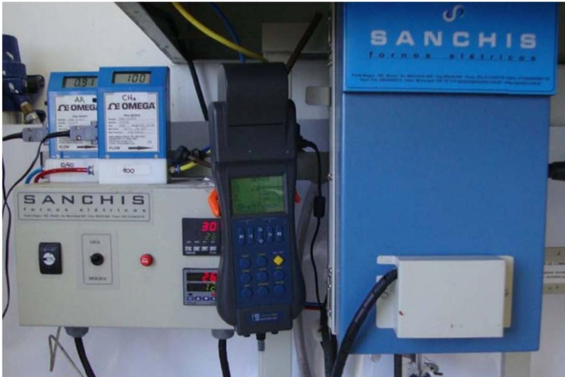
Figura 5.4. Montagem do equipamento de avaliação da atividade catalítica.
