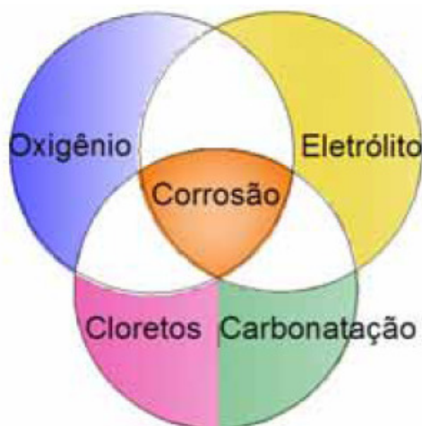
Figura 3: Condições para ocorrência da corrosão (BOHNI, 2005)
