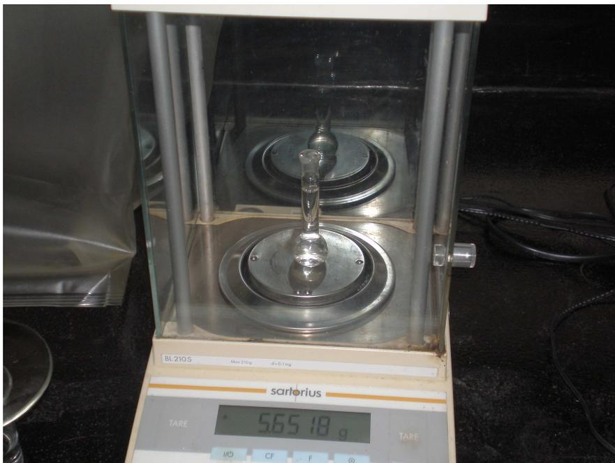
Pesagem do balão volumétrico pré e pós diluição
