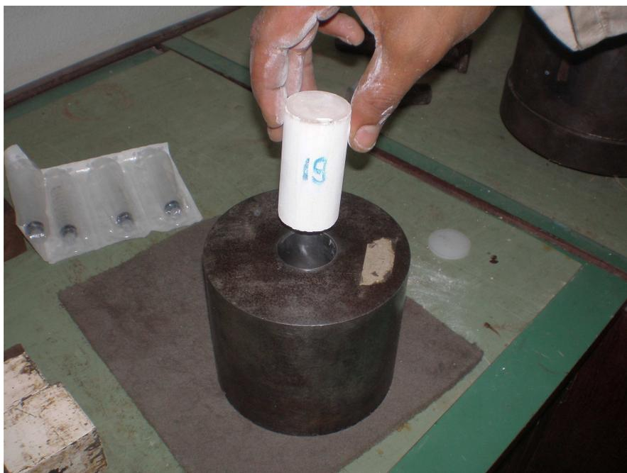
Detalhe da colocação do corpo-de-prova  $\Phi 40\text{mm} \times 80\text{mm}$
