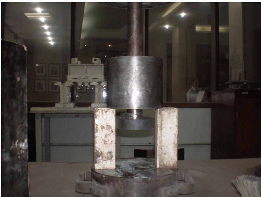
Detalhe da retirada do embolo após retirado o corpo-de-prova
