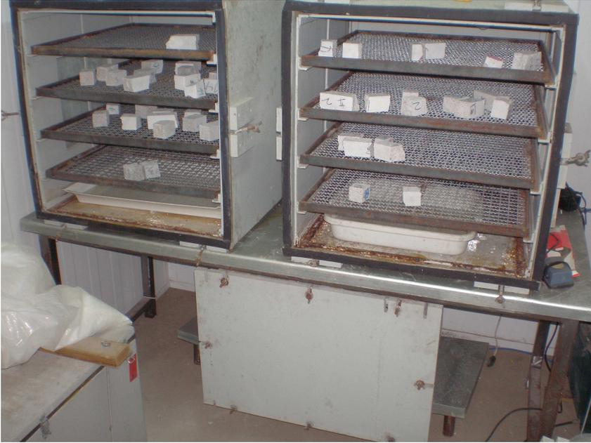
Figura 3.3. Vista geral do equipamento com ambas câmaras de carbonatação e caixa de passagem
