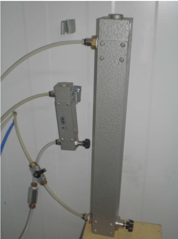
Figura 3.6 Detalhe dos 2 rotômetros utilizados. O rotômetro maior é o de ar comprimido e o menor de CO<sub>2</sub>
