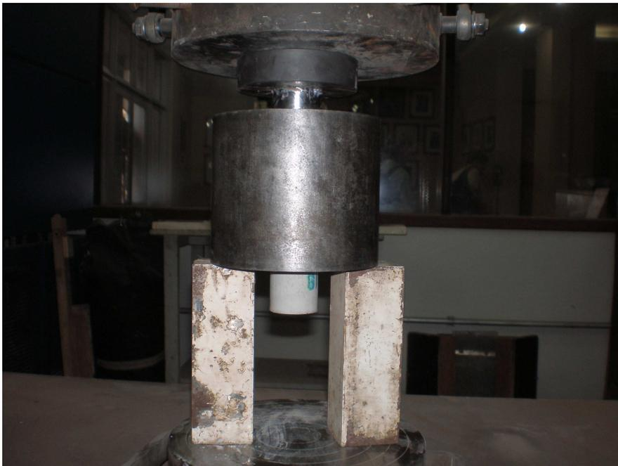
Detalhe da retirada do corpo-de-prova após o ensaio
