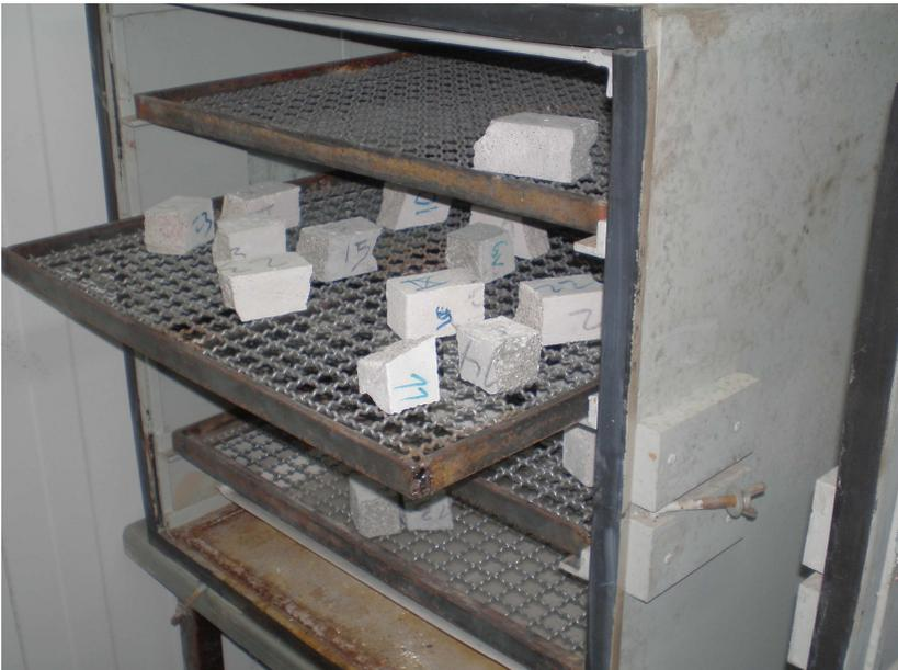
Figura 3.4 Detalhe das bandejas da câmara de carbonatação
