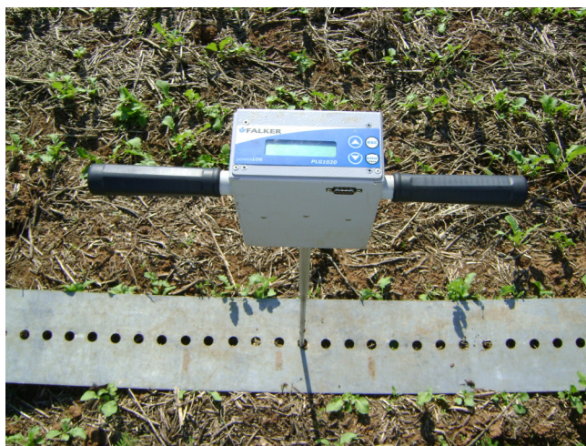
FIGURA 2. Penetrômetro utilizado para determinação da resistência do solo à penetração em janeiro de 2010.
