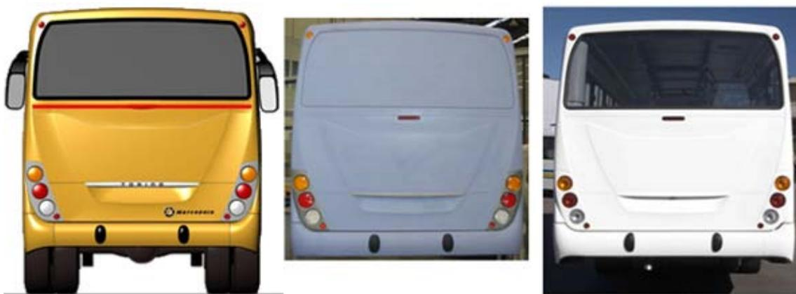
**Figura 26 – Traseira de um ônibus: projeto x fibra traseira x protótipo final**
