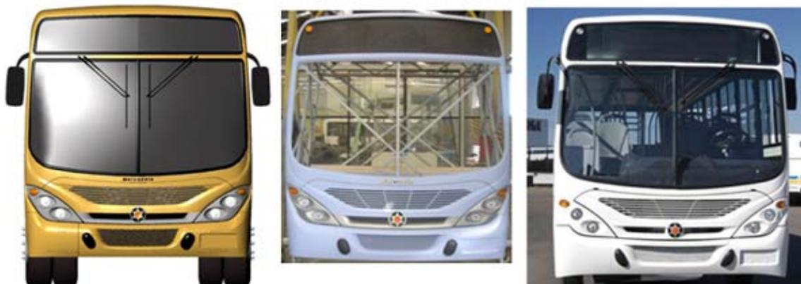
**Figura 27 – Frente de um ônibus: projeto x fibra frontal x protótipo final**
