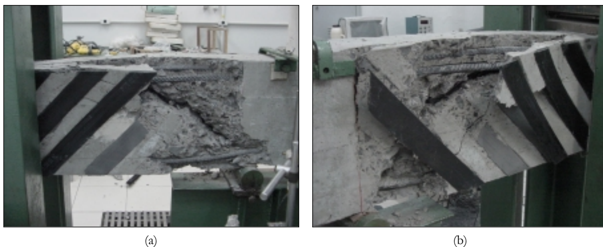
FIGURA 5-67 — Detalhe da ruptura das vigas reforçadas com laminados pré-fabricados
