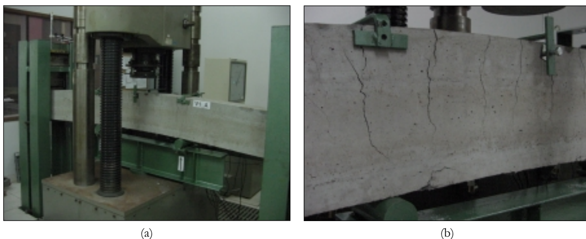
FIGURA 5-1 — Detalhes do modo de ruptura das vigas V1_A e V1_B
