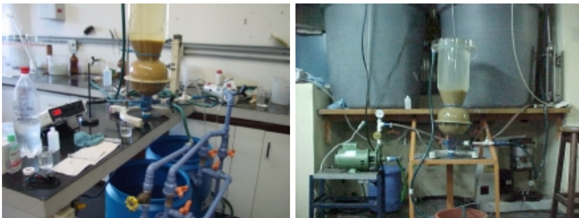
FIGURA 8 – Fotografia do esquema de montagem do REFA, tratando 200 e 800 L de efluente.
