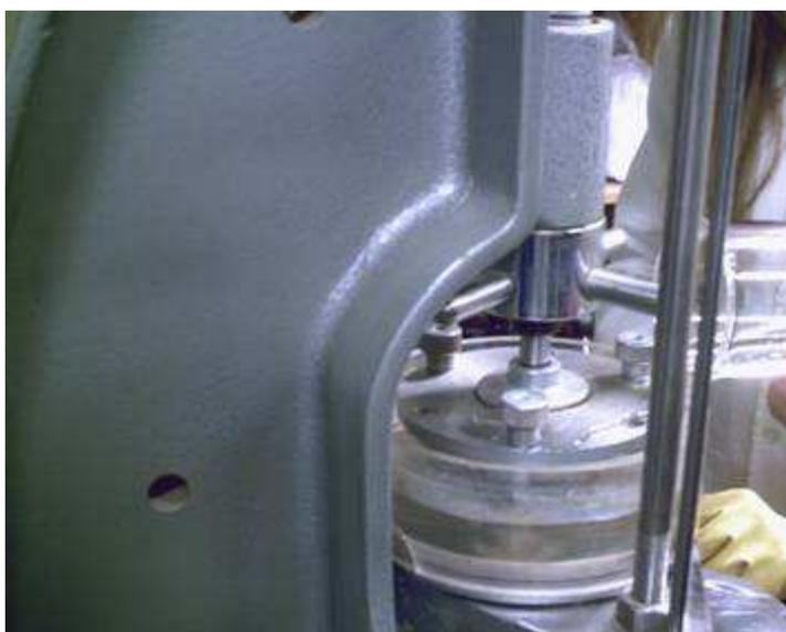
Figura 30: Foto da célula do oedômetro convencional sendo cheia com água (GAUER, 2007)
