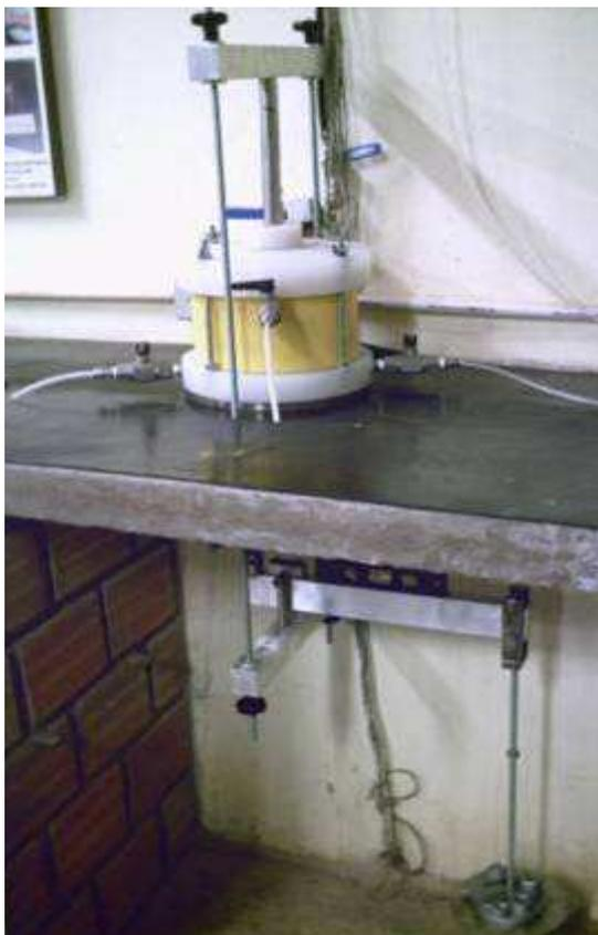
Figura 32: Foto da vista geral do oedômetro de lamas (GAUER, 2007)
