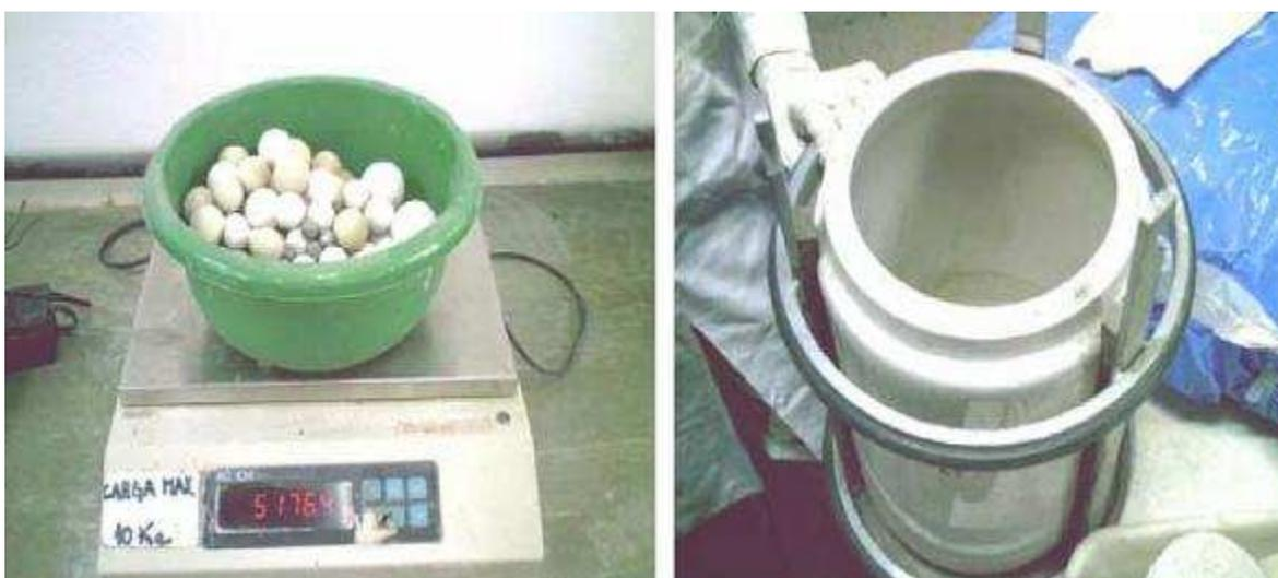
Figura 26: Bolas e jarro com capacidade de 7,5 kg utilizados na moagem (BEDIN, 2008)
