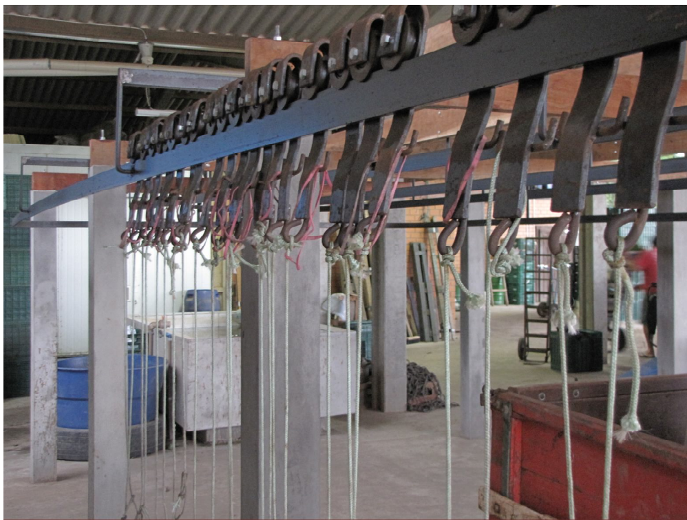
FIGURA 2. Detalhe dos cabos aéreos com tanque de alvenaria ao fundo para diminuir danos mecânicos.
