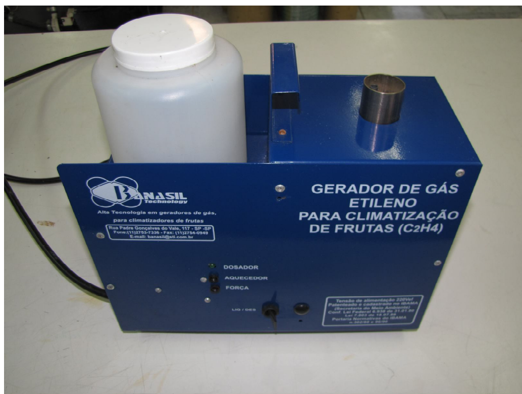
FIGURA 4. Detalhe do equipamento gerador de etileno.
